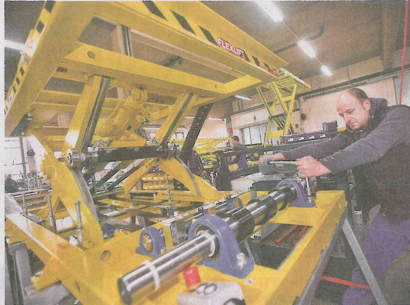
Hubtisch: Jakob Wolf montiert einen Hubtisch mit Riemenantrieb. Auf dem Gerät werden später Pkw gebaut, die Arbeiter können ihn individuell auf die für sie ergonomische Höhe einstellen.
