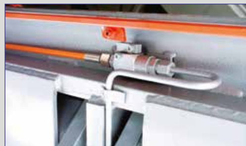
Hydraulisches Sicherheitsventil unter der Hubtischplattform
