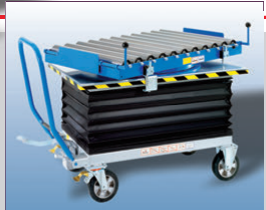
Transporthubwagen mit aufgebauter Rollenbahn und Faltenbalg, auch mit elektrischer Hydraulikpumpe
