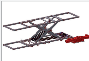
Motor außen liegend mit Standby-Motor
